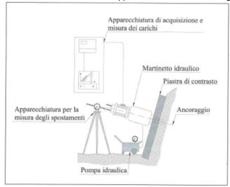
Gli strumenti devono consentire la misura del tiro applicato, preferibilmente per mezzo di una cella di carico in asse all'ancoraggio, l'allungamento dell'armatura, la pressione applicata al martinetto di tesatura. Inoltre, è opportuno che nel corso delle prove venga misurato lo spostamento (assoluto) della struttura di contrasto, prendendo come riferimento un punto fisso esterno alla zona che può essere influenzata dalla prova.
